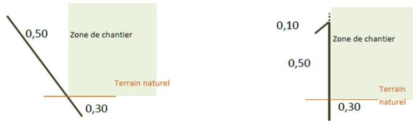
Figure 16 : Principe et caractéristique des clôtures contre l'intrusion des batraciens
